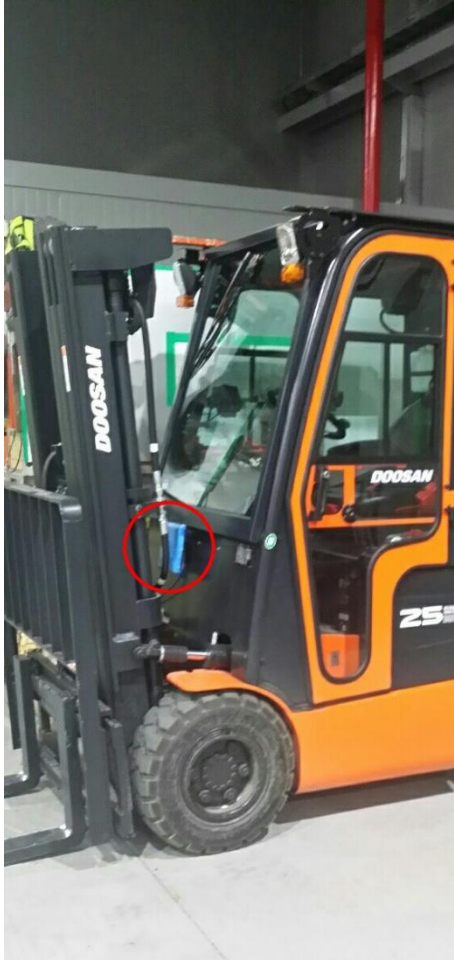
소형 지게차 RFID 안테나 설치
