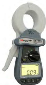
접지저항 측정기(클램프형)와 접지저항 측정 예
