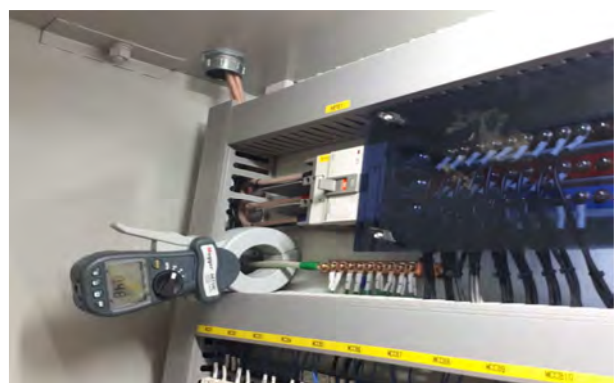
접지저항 측정기(클램프형)와 접지저항 측정 예
